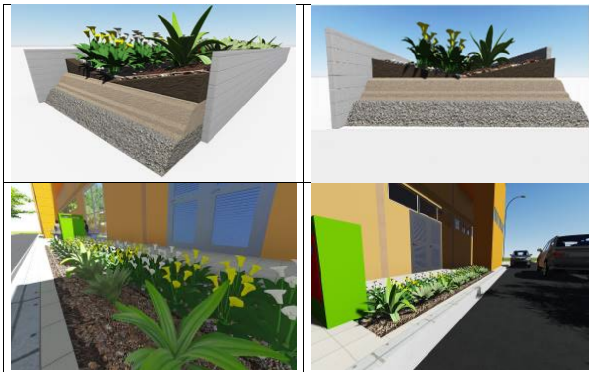
Figura 9-Esquemas do Projeto Executivo de Jardim Drenante, camadas de brita 2, areia e substrato.
